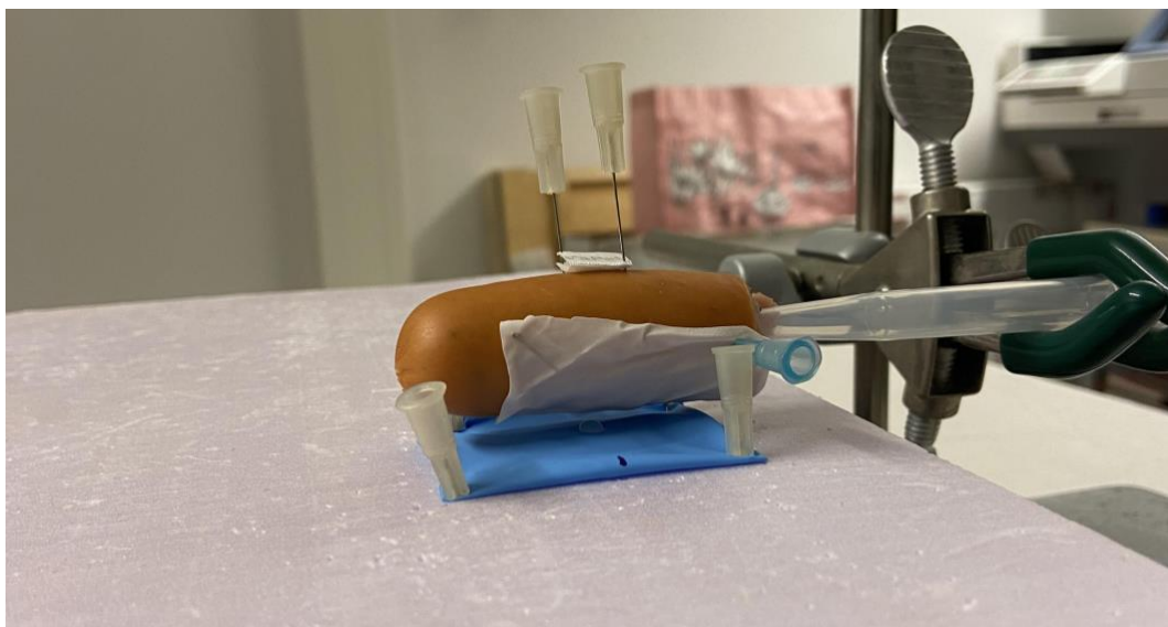
Figur 2. Uppställning för att testa handskarnas skydd mot konversionselektroner. En dosimeter placerades ovanpå korven med hjälp av små kanyler samt på undersidan, precis under skinnet.
