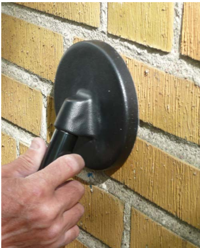
Bild 3.1. Lokalisering av kramlor med hjälp av en Elcometer på Rosengård i Malmö.
