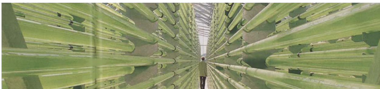
Figur 2. Slutna, tubulära fotobioreaktorer i växthus (Berg-Nielsen, 2006)
