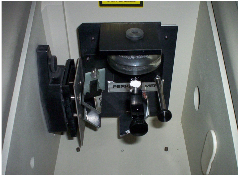
Bild 3: Scanning med diffus reflektans.
