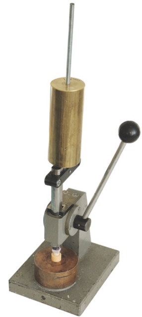
Figur 7. Normkrona under 1,5 kg press i specialtillverkat verktyg.
