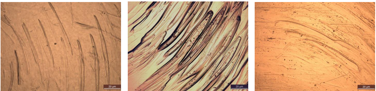
Bild 5-7. Efter slitagetest. Från vänster: varmpolymeriserat, fräst och 3D-printat material
