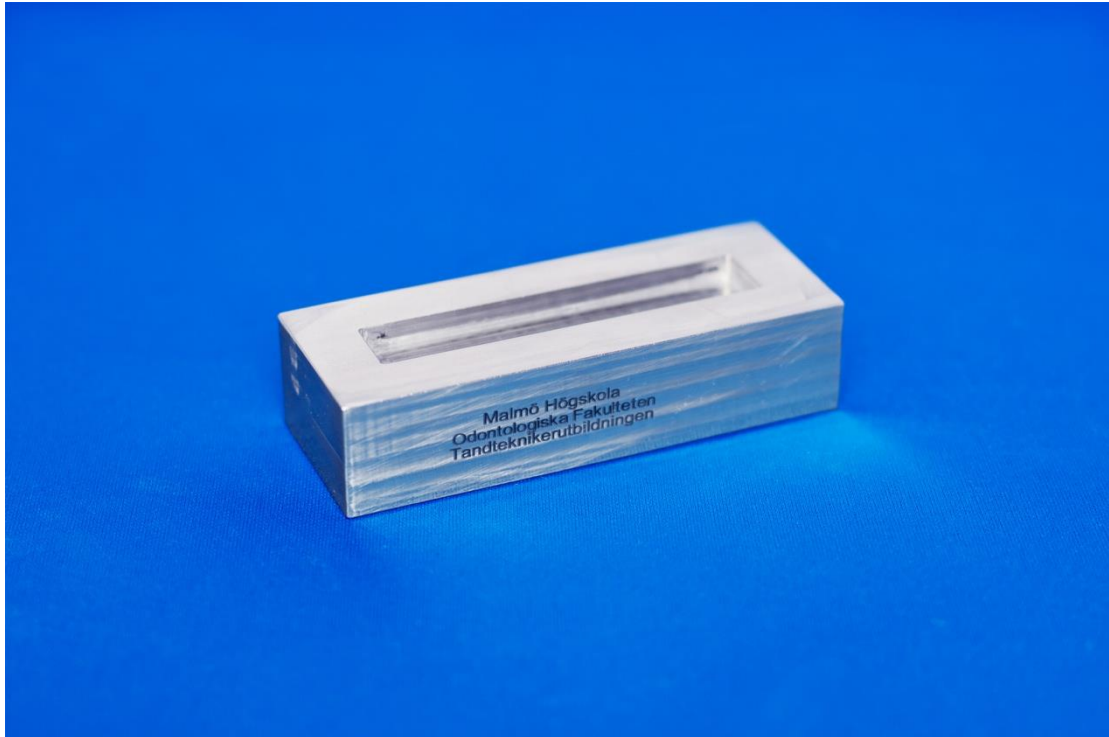
Bild 17. Specialtillverkad hållare i rostfritt stål
