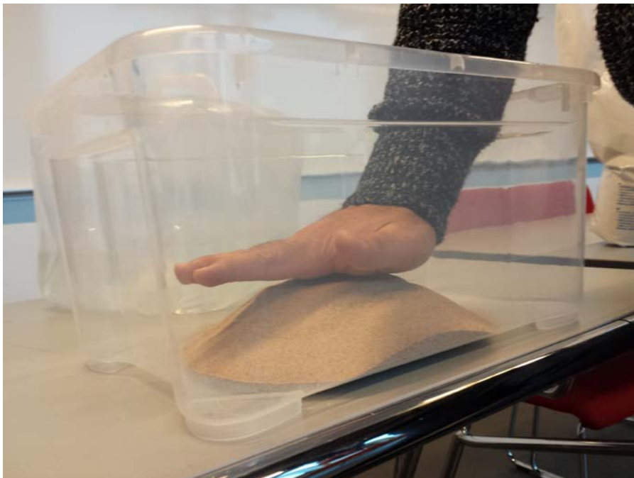
Figur 4.10: Manuell packning av sanden (Egen bild).
