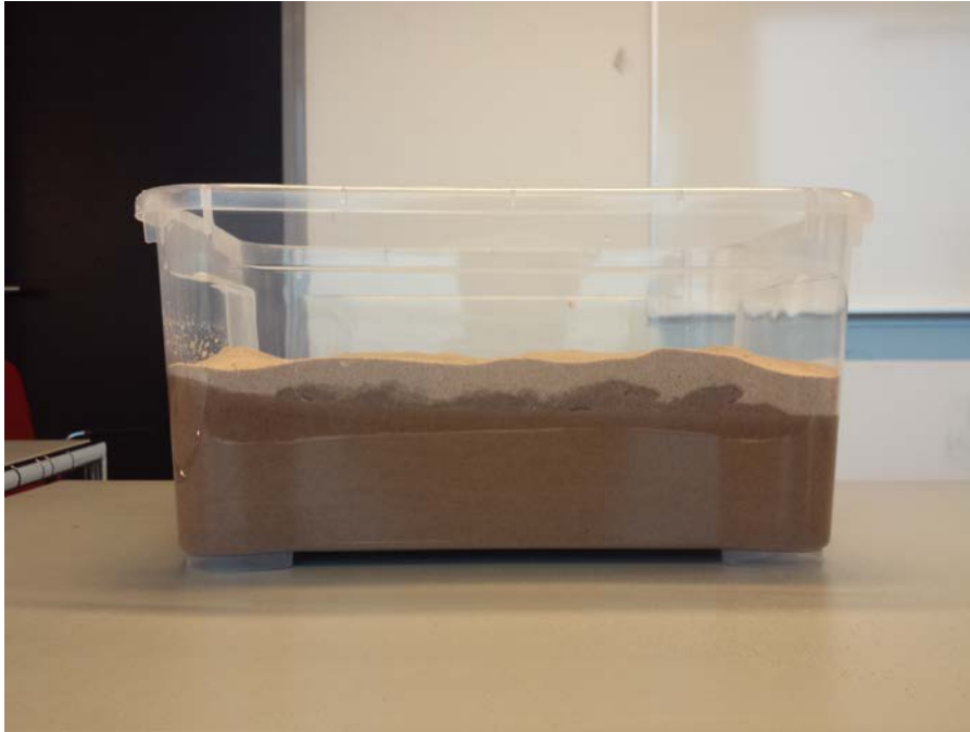
Figur 4.5: Fas 2; Sektion för den torra sandytan och dess grundvattennivå (Egen bild).
